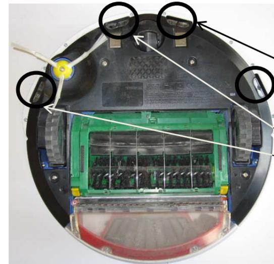
Les 4 capteurs inférieurs, permettent la détection du vide. La diode émettrice envoie un signal continu à la diode réceptrice. Lorsque le signal se coupe, le robot a ordre de s'arrêter et de faire un demi-tour.
