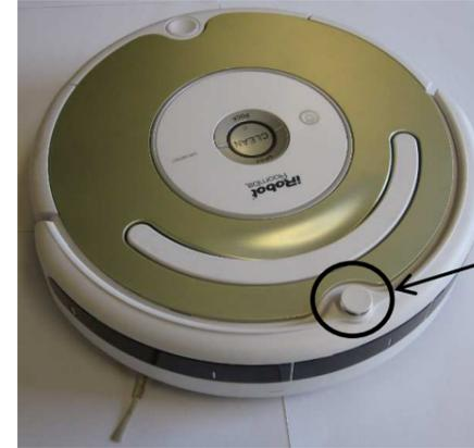
Le capteur supérieur permet la détection de la base, en fin de phase de nettoyage, ou lorsque le robot est pratiquement déchargé. La diode émettrice du robot envoie un signal à la diode réceptrice placée sur la base.
